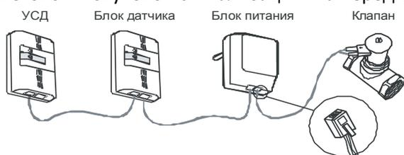
Рисунок 1 – Сигнализатор оксида углерода "БУГ" двухблочного
